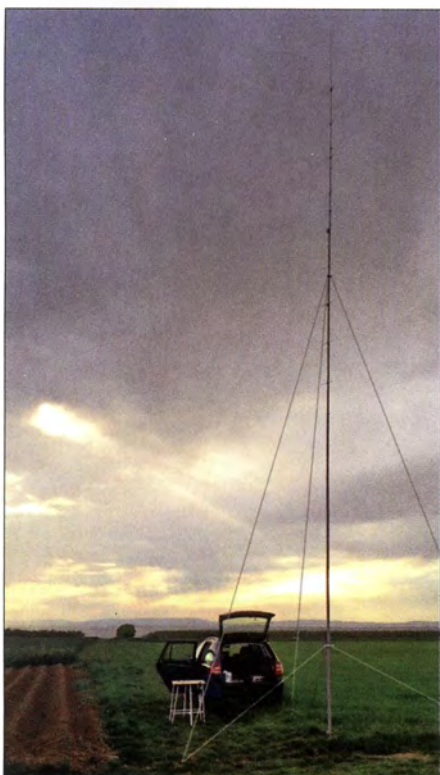
Bild 1: Aufgestellter Mast mit Abspannungen; oben ist eine Achtfach-Quadlong-Antenne nach DK7ZB befestigt.
