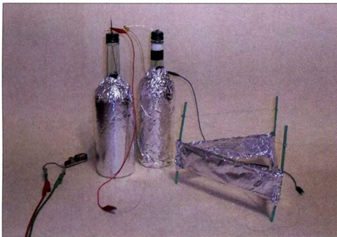
Bild 1: Bei diesem Versuchsaufbau wird ein sogenannter Lifter aus einem dünnen Draht und Aluminiumfolie mit der Energie aus der Leidener Flasche angehoben.
