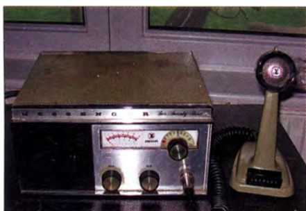
Bild 1: Dieses 23-Kanal-Gerät von Johnson, Typ Messenger 223, mit dazugehörigem Standmikrofon war mein erster CB-Transceiver aus den USA.
