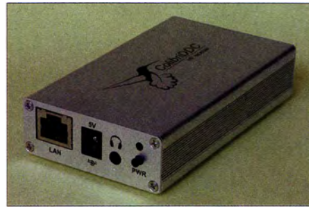
Bild 2: Rückseite des Colibri DDC mit LAN-, Stromversorgungs- und Kopfhörerbuchse
