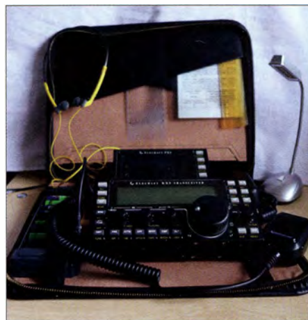
Bild 10: Mit einer Schreibmappe, die Akkumulatoren, Transceiver und Panoramadisplay aufnimmt, ist man unterwegs unauffällig QRV. Foto: DH6RD
