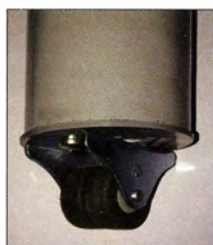
Bild 3: Der drehbare Mastfuß steht in einer DN75-HT-Muffe, der Zwischenraum ist mit speziell zugeschnittenen HT-Rohrteilen aufgefüllt.
