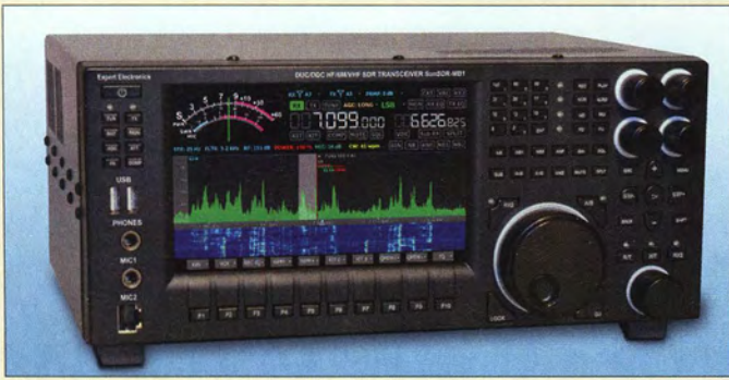
Auf dem großen Farbdisplay des MB1 werden Wasserfalldiagramm und Spektrum angezeigt.
