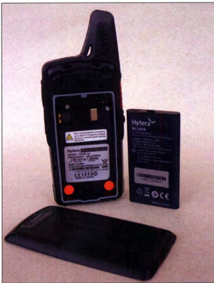
Der 2-Ah-Lithium-Ionen-Akkumulator nimmt die Rückseite ein und ist für 3 W Sendeleistung gut.
