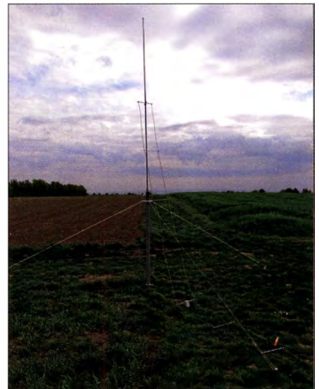
Bild 16: Teilweise ausgeschobener Antennen- mast mit angebrachter Quadlong-Antenne für das 2-m-Band Fotos: DK2FQ
