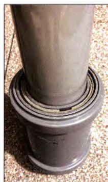
Bild 3: Der drehbare Mastfuß steht in einer DN75-HT-Muffe, der Zwischenraum ist mit speziell zugeschnittenen HT-Rohrteilen aufgefüllt.
