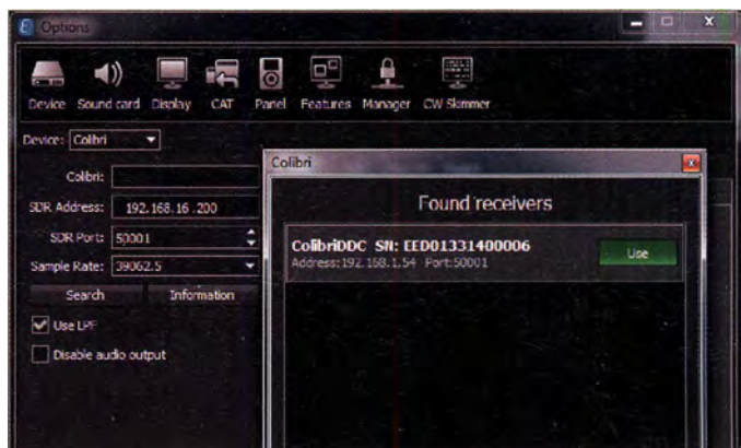
Bild 6: Erfolgreiche Konfiguration des Colibri DDC in der Expert SDR2-Software
