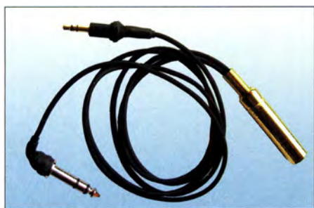
Bild 1: Kabel für die Verbindung einer Morsetaste mit zwei Transceivern Fotos: DJ6CA
