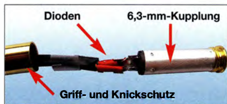
Bild 3: Vier Dioden lassen sich noch gut in der 6,3-mm-Kupplung unterbringen.
