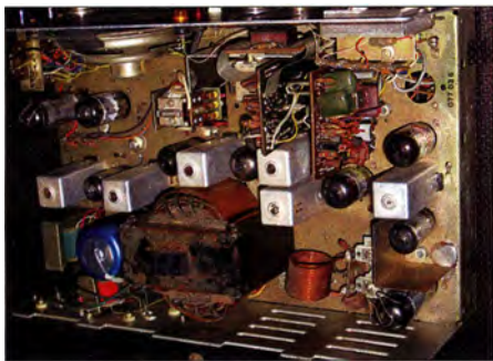
Bild 5: Geöffnetes 40-Kanal-Gerät Teaberry Model T; von oben sieht man links neben dem Relais zwei senkrechte Platinen, die im PLL-Verfahren Frequenzen für Senden und Empfang erzeugen.
