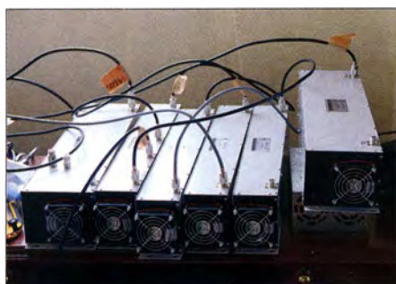
Das 403A-High Power HF-Triplexer-System ermöglichte, drei Stationen gleichzeitig an unserem 3-Band-Force-12-Beam mit einer Einzel-Koaxialspeiseleitung zu betreiben.
