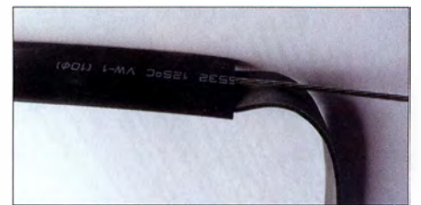
Bild 9: Einführen der Gummistreifen in den Schrumpfschlauch
