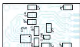
Bild 7: Bestückungsplan der Unterseite (SMD-Seite)
