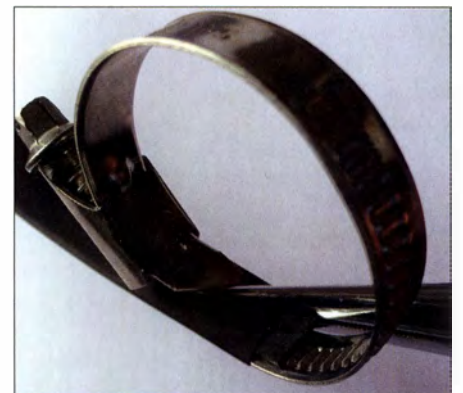
Bild 10: Aufziehen des gefütterten Schrumpfschlauchs auf die Schlauchschelle
