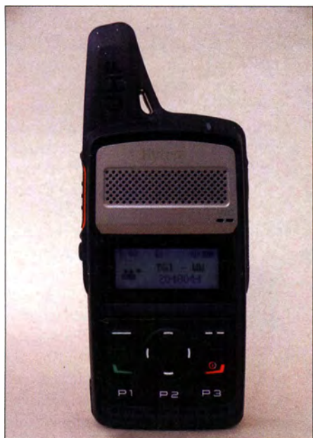
Die Antenne ist ohne Anschlussbuchse fest ins Gehäuse integriert.
