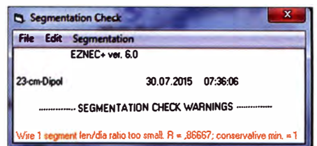
Bild 4: Fehlermeldung beim Segmentierungs-Check, weil bei Wire 1 die Segmentlänge geringer als der Durchmesser ist
