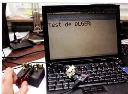
Bild 14: Einsatz des Keyers als Morsetastatur an einem PC
