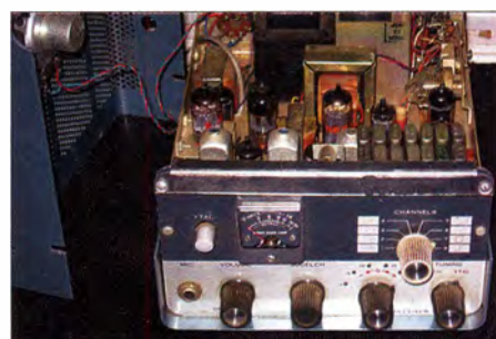
Bild 4: Sonar Model G; rechts neben dem Transformator (schwarz) liegt die Zenerhackerpatrone.
