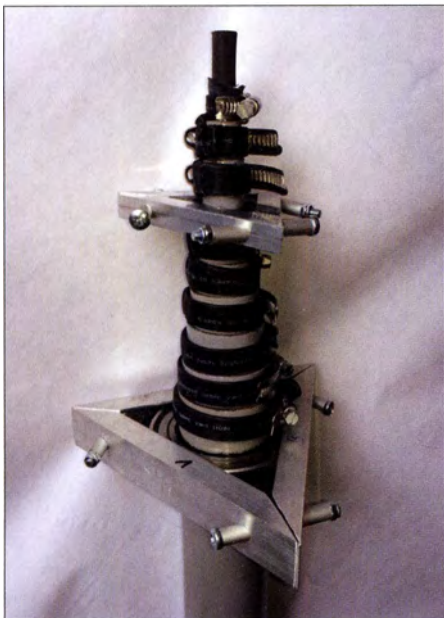
Bild 5: Mastelemente mit den Oberlagern und den Sicherungsschellen
