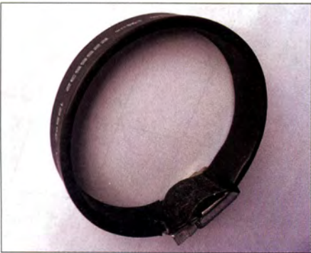
Bild 12: Schrumpfschlauch nach der Hitzebe- handlung
