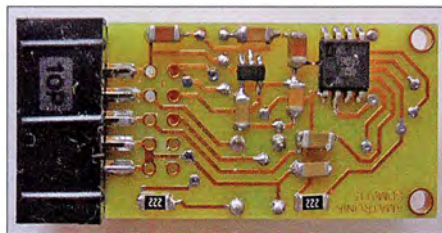
Bild 2: Unterseite des Soundmoduls mit den SMD-Bauteilen
