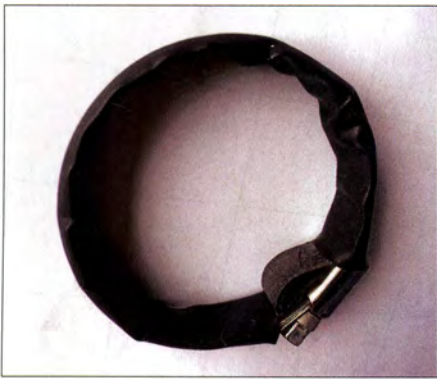
Bild 11: Schlauchschelle mit fertig aufgezo- genem Schrumpfschlauch
