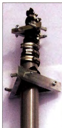
Bild 13: Oberteil des zusammengescho- benen, komplett ausgerüsteten GFK-Mastes mit den Schlauchschellen und den beiden Oberlagern
