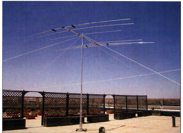
Ein Blick auf unseren auf dem Dach des Hotels montierten Force-12-Beam für 10 m, 15 m und 20 m Fotos: E30FB
