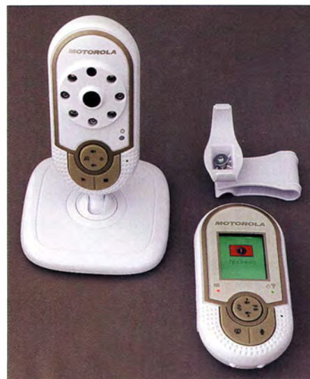
Kamera (links) und Empfangseinheit (rechts) des Motorola MBP28 Foto: DL2MCD
