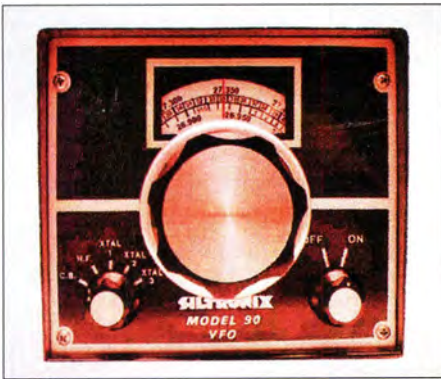
Bild 12: Mit dem linken Schalter stellt man in der Stellung „HF“ den externen VFO auf Frequenzen oberhalb von 27,395 MHz um. Fotos: DH7XU
