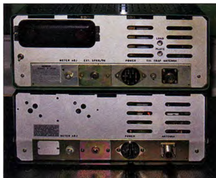
Bild 10: Rückseite des Robyn T-123 sowie des Teaberry Model T, einmal mit Spannungswandler, einmal ohne; die Transistoren befinden sich hinter der schwarzen Lochblende. Bei dem unteren Gerät erfolgt die Load- und Plate-Einstellung von oben durch das Gehäuse mit einem langen Schraubendreher.
