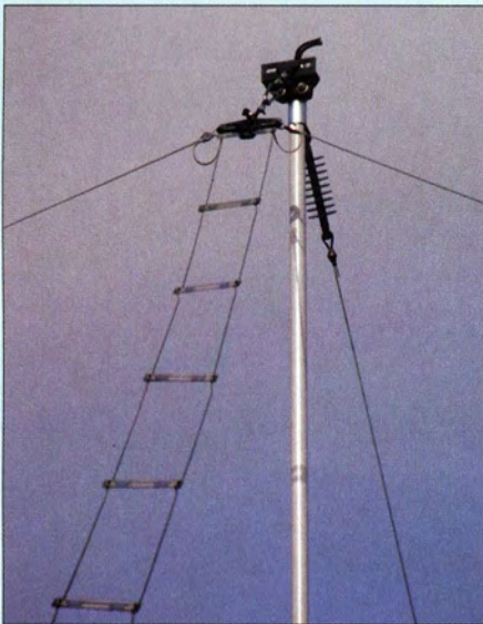
Bild 1: Einspeisepunkt des aufgebauten 2 x 10-m-Dipols mit Zweidrahtleitung, dahinter der Endisolator der Empfangsantenne
