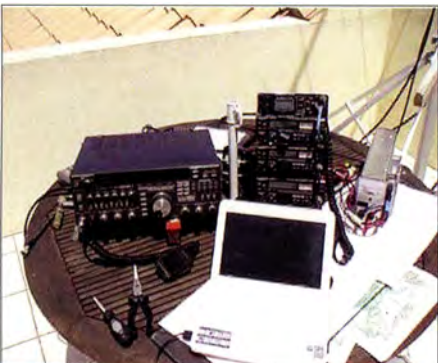
Die Stationsausrüstung im Dachterrassen-Shack: TR-751, TR-851, FT-736R für 23 cm sowie TR-751 mit 3-cm-Transverter (DB6NT) und 10-W-PA von DL2AM. Fotos: DG3MIM
