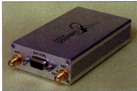
Bild 1: Vorderseite mit Buchsen für Antenne, Steuerung und Frequenzreferenz
